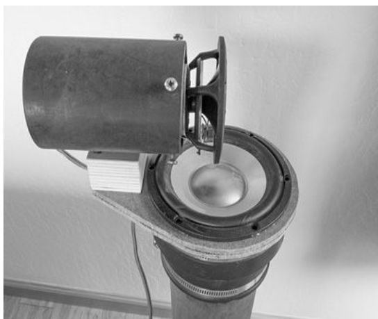
Obrázek 19. Akusticky shodné rozložení basového a širokopásmového reproduktoru s válcovým rozptylovým tělesem za ním.
