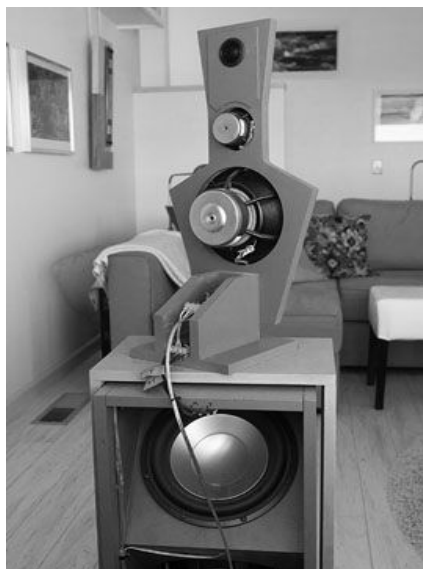
Obrázek 13. Zadní strana otevřené ozvučnice reproduktorové soustavy. Zvuky vyzařované směrem dozadu, jsou opačné polarity oproti zvukům vyzařovaným dopředu. Tvar a hloubka otevřené ozvučnice určuje délku dráhy a tím i velikost fázového posunu a tím míru, do jaké zruší vyzařování zadní strany reproduktorů zvuk, vyzařovaný do frontální polokoule.
